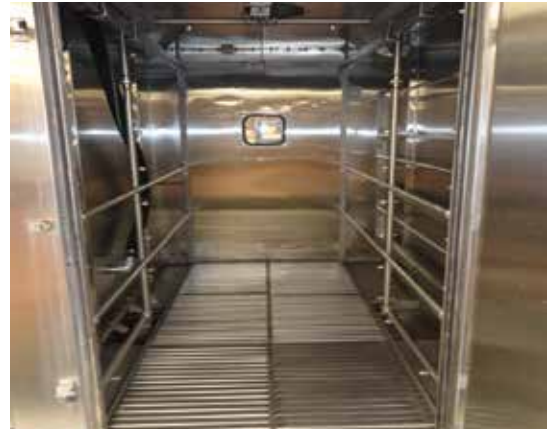
不锈钢笼架清洗机现在已完全没有水垢
