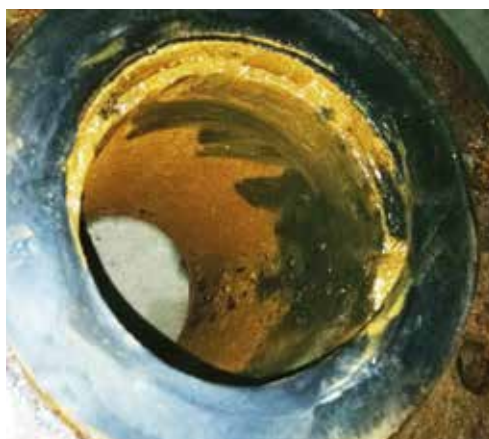
水垢轻轻一擦就掉，露出阀体光滑内壁
