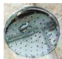
安装沃肯(Vulcan)装置两个月后的淋浴喷头积垢减少
