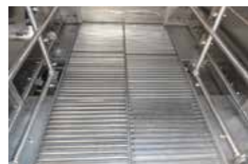
不锈钢笼架清洗机现在已完全没有水垢
