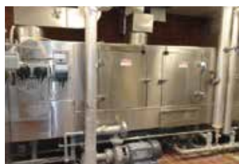
不锈钢笼架清洗机现在已完全没有水垢
