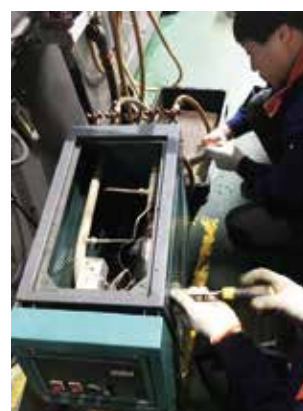
安装沃肯(Vulcan)一年半后 拆开模温机检查换热器
